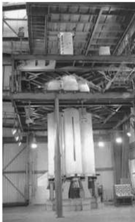
FIG. 2.2: Dispositivo para ensaio dos modos de flexão da estrutura do VLS.
